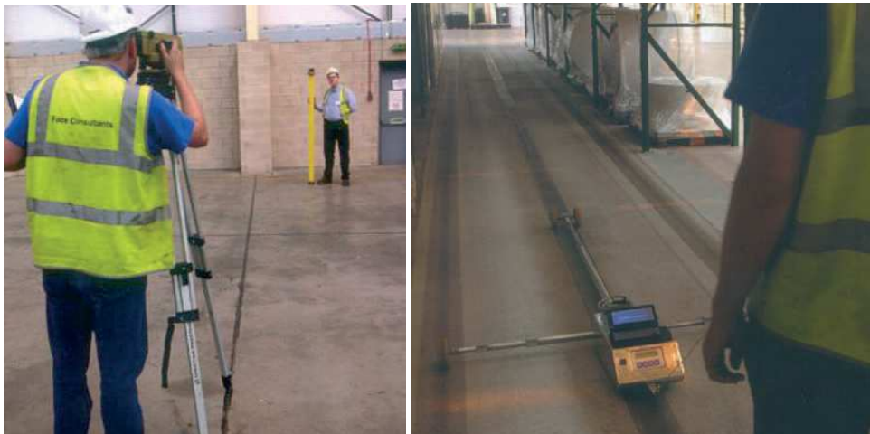
1-2. kép: Ipari padló geometriájának átadáskori és használat közbeni mérések ellenőrzése
